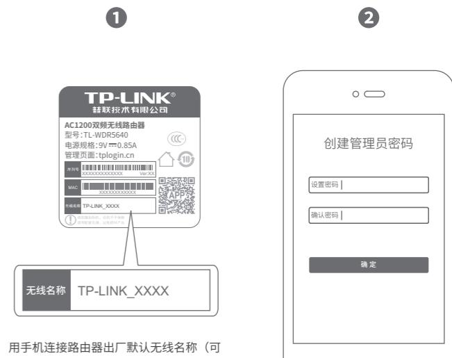
用手机连接路由器出厂默认无线名称（可在路由器底部的产品规格标贴上查找）。
